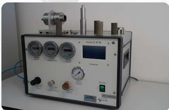
ЛАБОРАТОРНАЯ УСТАНОВКА ДЛЯ ИЗМЕРЕНИЯ ГАЗОВОЙ ПРОНИЦАЕМОСТИ ГЕОПРОН ДС 30\100
