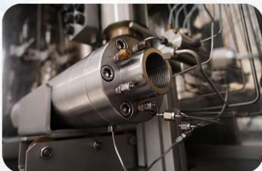
УСТАНОВКА CFS-800 ДЛЯ ИССЛЕДОВАНИЯ НЕФТЕВЫТЕСНЕНИЯ
