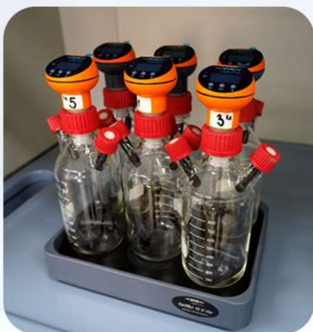
МАНОМЕТРИЧЕСКАЯ СИСТЕМА ИЗМЕРЕНИЯ ВЫСОКОЙ ДЫХАТЕЛЬНОЙ АКТИВНОСТИ ПОЧВЫ
